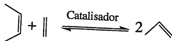
Figura 2: Reação de produção de propeno a partir da metátese de olefinas
