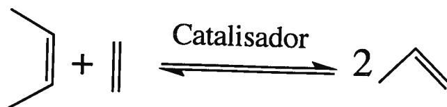
Figura 2: Reação de produção de propeno a partir da metátese de olefinas
